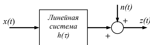
Рис. 5.9. Обозначения, используемые для описания системы с одним входом и одним выходом
