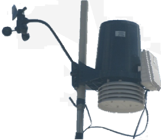
Рисунок 1. – Автоматическая метеостанция кафедры КСМ ДонНТУ
