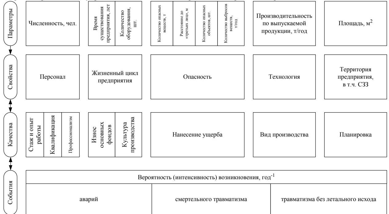
Рисунок 4. – Упрощенная схема опасного предприятия как сложной системы
