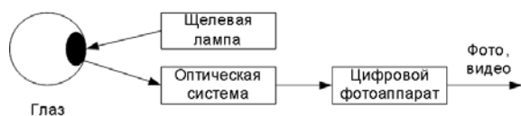
Рисунок 1. – Структура установки для исследования микроциркуляции
