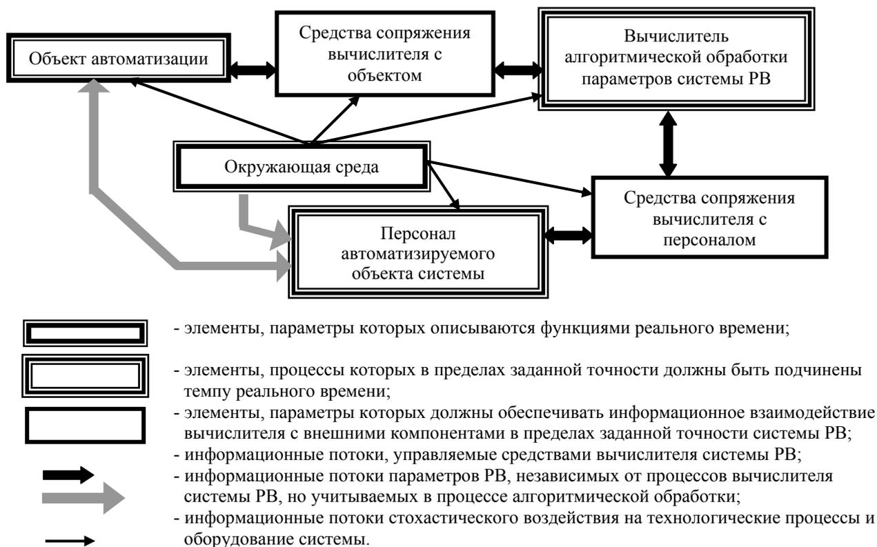
Рисунок 1. – Обобщенная структура системы РВ как основа системы автоматизации технологических процессов объекта
