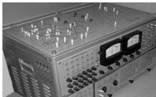
В компьютере МН-7 присутствуют все базовые компоненты типового аналогового вычислителя
