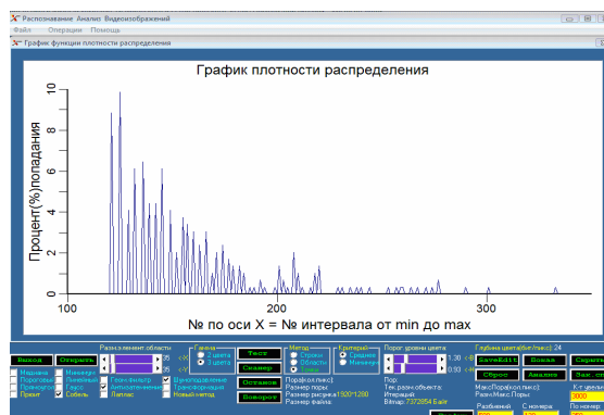
Рисунок 3. – График плотности распределения числа пор как функции эффективного диаметра ( N = 500, n1 = 120, n2 = 350 )
