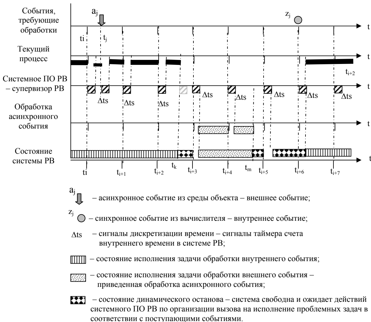
Рисунок 3. – Диаграмма управления приведенной обработкой асинхронного события
