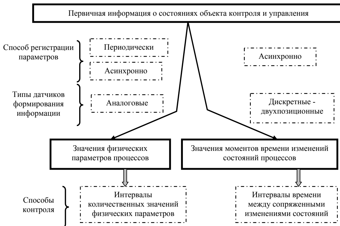
Рисунок 1. – Структура первичной информации АСУ ТП о текущих состояниях процессов объекта
