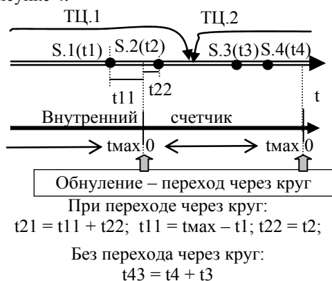
Рисунок 4. – Диаграммы расчета длин интервалов при круговом счете
