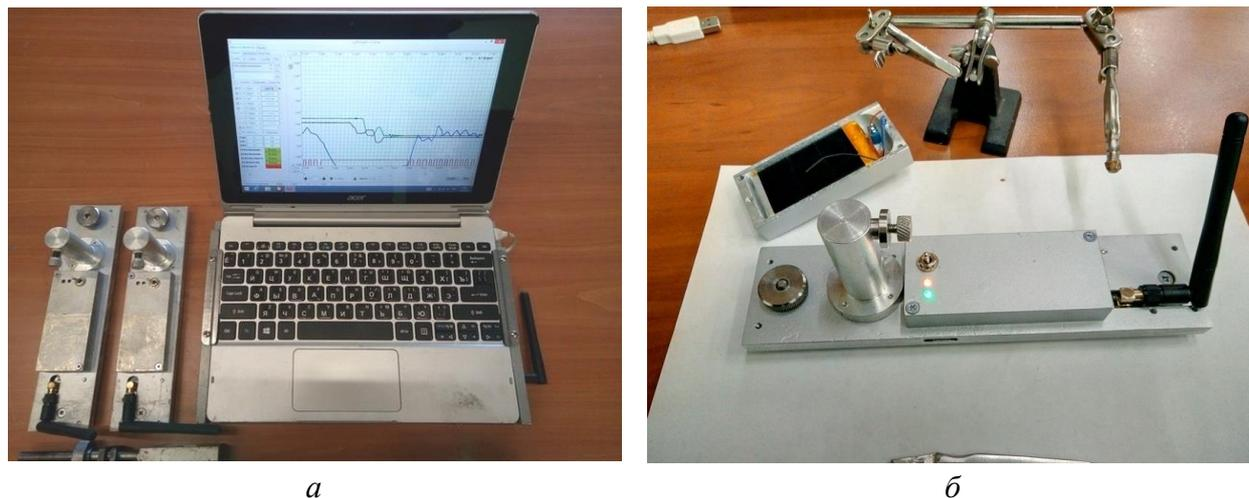
Рис. 1. Основной блок комплекса диагностики ШСУ (а) и беспроводный датчик (б)
