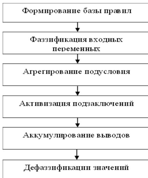
Рис.5. Алгоритм работы системы нечеткого логического вывода
