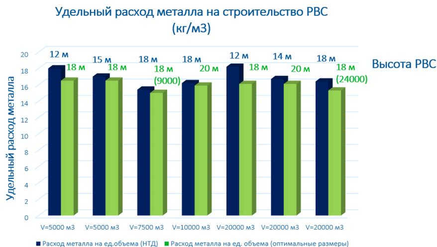
Рисунок 2. Сравнительный анализ удельного расхода металла на сооружение РВС
