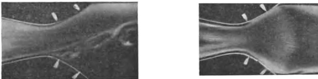
Рис. 4. Вследствие отсасывания пограничного слоя, отрыв потока отсутствует
