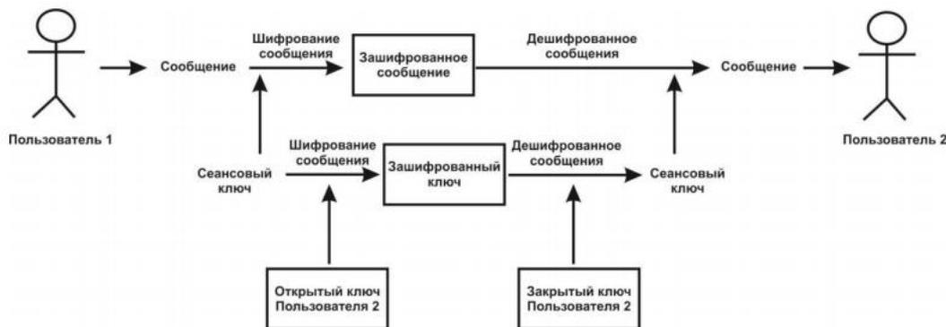
Рис. 1. Гибридная схема шифрования
