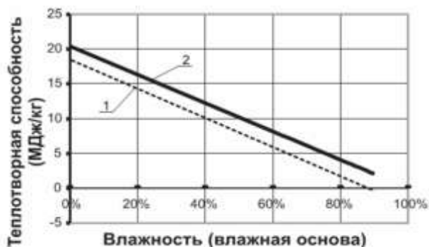
Рисунок 4 – Воздействие влаги на величину теплоты сгорания древесины
